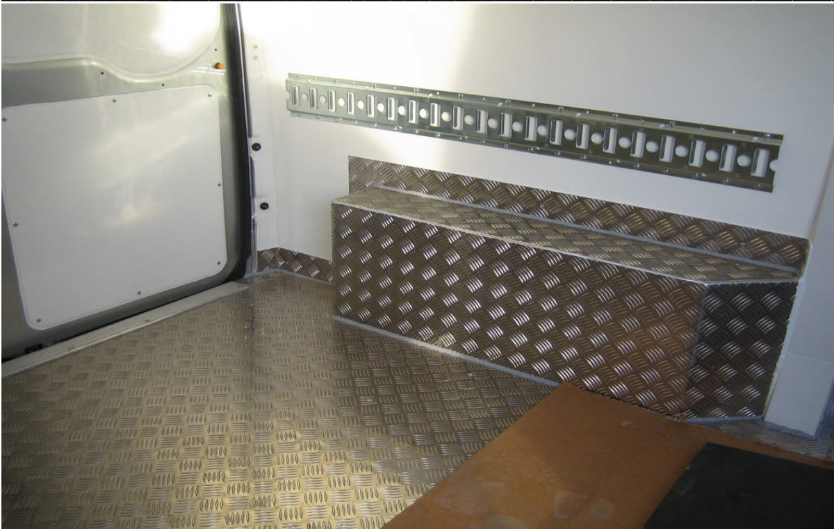
TYYLIKÄS JA KESTÄVÄ ALUMIINI TURKKILEVY LATTIA JA PYÖRÄKOTELOT
