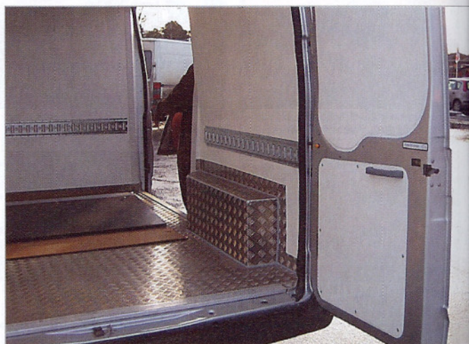
Seinien sileä geelipinta ja lattian turkkilevy tekevät kuormatilasta helposti puhdistettavan. Zanotti kylmälaitteisiin on mahdollista liittää myös tietokonepohjainen lämpötilan seurantajärjestelmä kuittitilustusmahdollisuudella.
