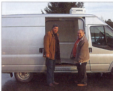
Jorma Suvanto (oik) ja Tarmo Paekivi tarkastavat VR:lle matkaavaa uuden sukupolven Transitia. Katolla sijaitseva Zanottin lauhdutinyksikkö tuottaa kylmää, mutta tarvittaessa lämpöpumpulla varustettuna myös lämmintä.
