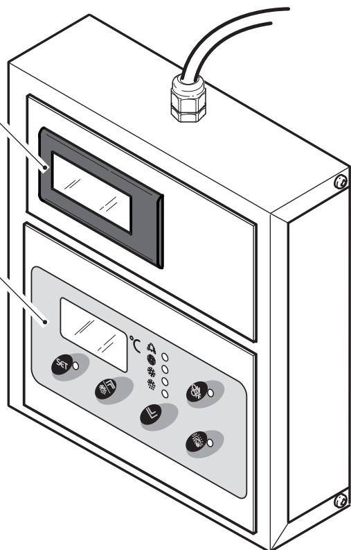
El **módulo alarmas** es un dispositivo que permite controlar hasta 5 señalizaciones de alarma, las cuales pueden aumentar hasta 10 aplicando un módulo slave. Gracias a la salida serial RS485, el módulo alarmas, con el eventual slave, puede integrarse en el sistema de monitoraje XJ500.
