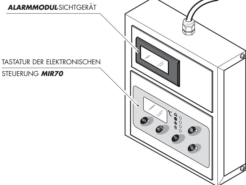
Das **Alarmmodul** ist eine Vorrichtung, die bis 5 Notmeldungen steuert, die auch 10 sein können, indem man ein Slave-Modul anwendet. Dank der seriellen Ausgang RS485 kann das Alarmmodul (mit eventuellem Slave-Modul) mit einem Überwachungssystem XJ500 in Verbindung gesetzt werden. Die Alarmmeldungen und die entsprechenden Ausgänge werden in folgender Tabellen beschrieben.
