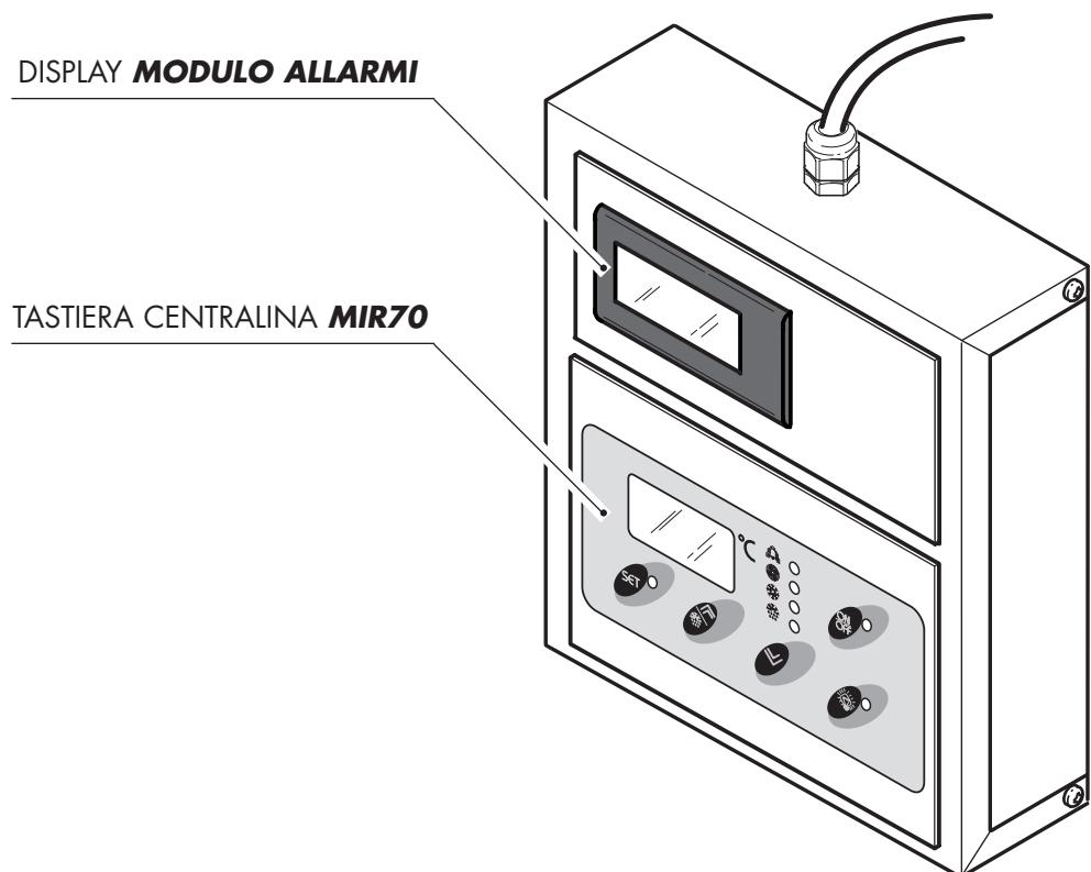
Il **modulo allarmi** è un dispositivo che consente di gestire fino a 5 segnalazioni d'allarme, espandibili a 10 applicando un modulo slave. Grazie all'uscita seriale RS485 il modulo allarmi, con l'eventuale slave, può essere integrato nel sistema di monitoraggio XJ500. Le segnalazioni degli allarmi e il relativo stato dell'uscita sono descritti nella tabella seguente.
