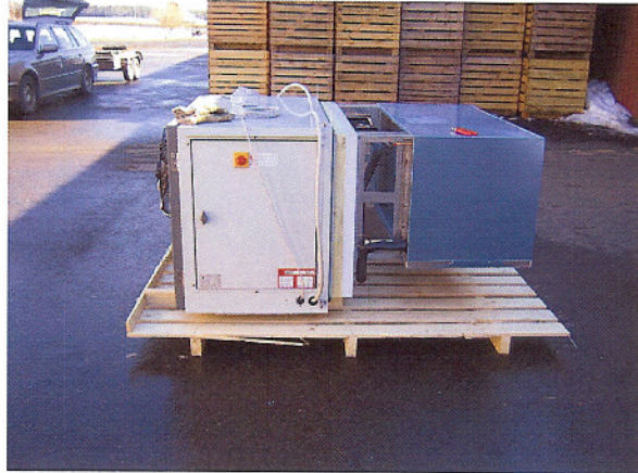
IDN 400 kylmäkone valmiina asennettavaksi kylmävaraston seinään. MYLLYVAINION PERUNA Kalajoki
